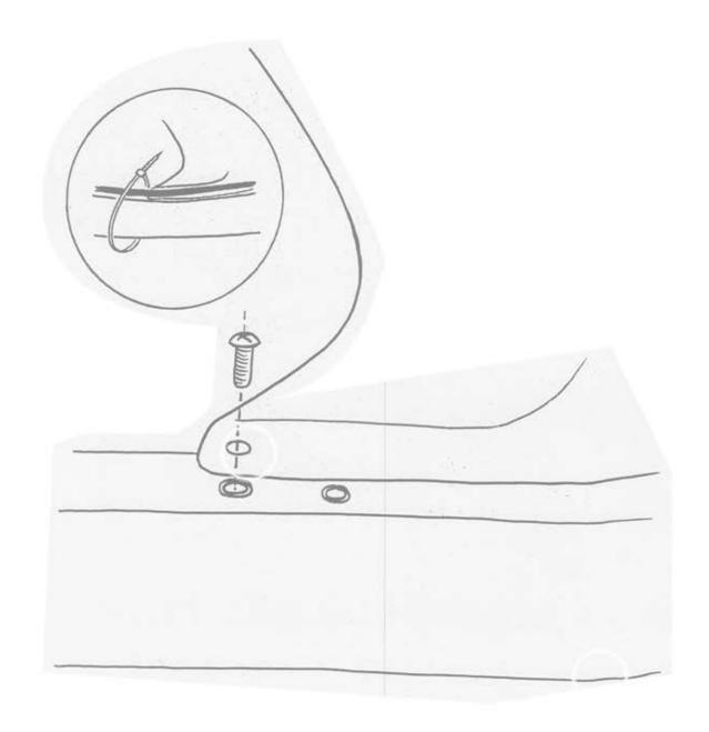
FIX THE BARRACUDA REAR FENDER ON THE MOTORBIKE FORK WITH THE SCREW ON THE CHAIN COVER SIDE AND USE THE ORIGINAL SCREW ON THE OPPOSITE SIDE.
