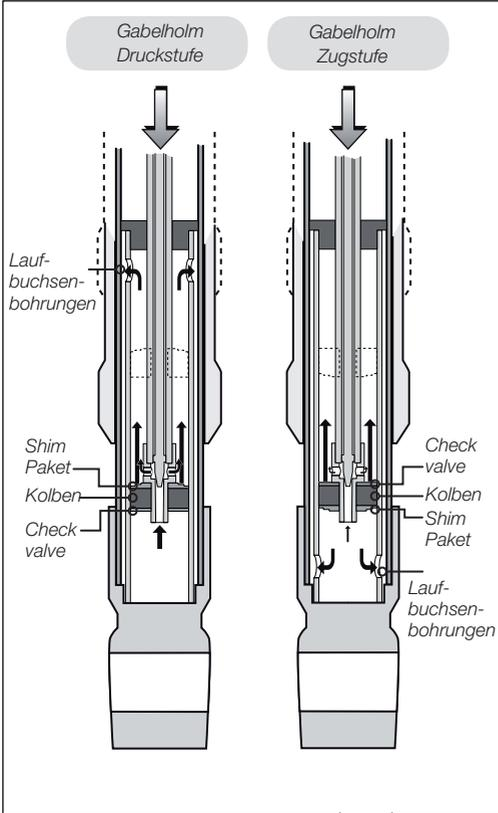
Abb. 5 – Vorderradgabel Ölfluss beim Ausfedern
