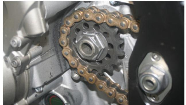
\* Die Federvorgänge des Hinterrades führen zu einer Abstandsänderung, da der Schwingendrehpunkt und die Getriebeausgangswelle mit dem Kettenritzel üblicherweise nicht koaxial liegen. Dadurch wird die Kette in einem schnellen Wechsel ge- und entspannt. Beim Einfedern nimmt die Zuglast zu.
