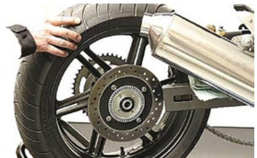
Ebenfalls wird empfohlen, die Befestigungsmuttern des Kettenrades auf diese Weise zu lockern. Nach Lösen der Achsmutter des Hinterrades, das Rad demontieren. Nun können Sie das Kettenrad am ausgebauten Hinterrad leicht austauschen. Bei dieser Gelegenheit prüfen Sie am besten auch die Radlager und begutachten Sie ebenfalls die Ruckdämpfer des Kettenradträgers. Sind diese verformt, rissig oder zeigen einen sonstigen Verschleiß, gleich ersetzen!
