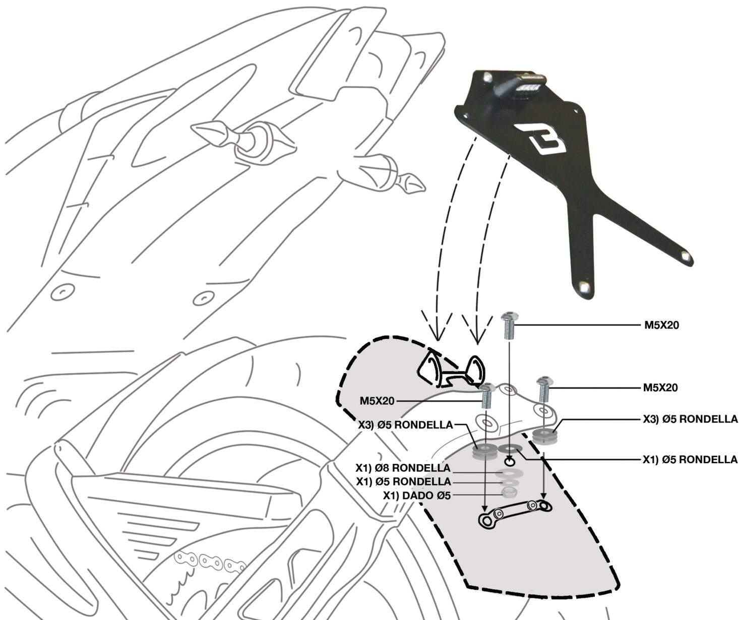
NOTE: SI CONSIGLIA, DI MANTENERE UN INCLINAZIONE NON SUPERIORE A 30° PER NON INCOMBERE IN SANZIONI DEL CODICE DELLA STRADA E PER EVITARE POSSIBILI ROTTURE STRUTTURALI
