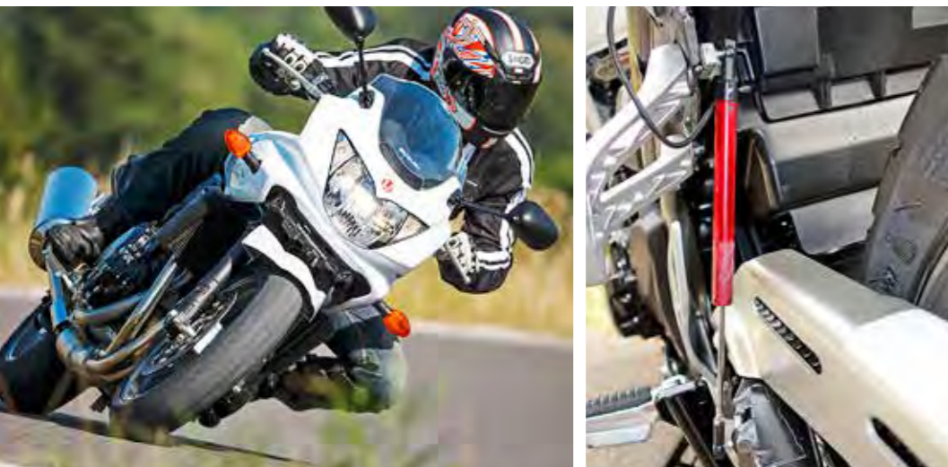
Kurz fällt die Tragfeder, dick die Kolbenstange des Nivomat-Dämpfers aus. Im Vergleich zu herkömmlichen Federbeinen ist er um 180 Grad gedreht montiert. Per Federwegsensoren wurde der Hub des Dämpfers auf den Teststrecken ermittelt
