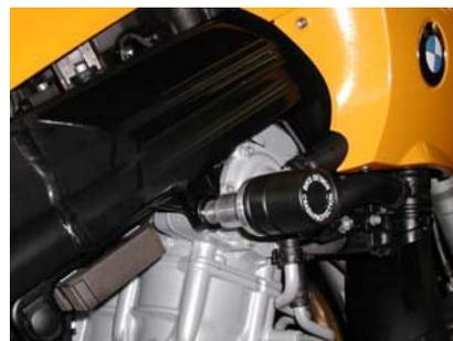
**ACHTUNG: Alle Schrauben müssen mit Sicherungsmittel (Loctite, mittlere Stärke) behandelt werden! Drehmomentangaben des Fahrzeugherstellers beachten!**
