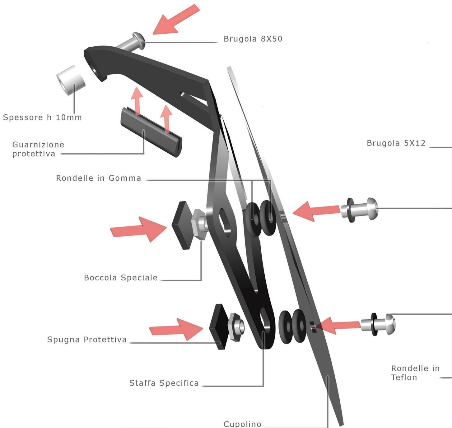
ASSEMBLARE IL CUPOLINO BARRACUDA USANDO LE VITI E GLI SPESSORI IN DOTAZIONE NEL KIT. MONTARE IL TUTTO COME DA ISTRUZIONI. IN FINE SVITARE I BULLONI DELLA FORCELLA (SUPERIORE) E SOSTITUIRLI CON LE BRUGOLE 8X50 INSIEME ALLO SPESSORE DI h10. SI CONSIGLIA DI STRINGERE IL TUTTO UNA VOLTA MONTATO IL CUPOLINO IN MODO DA EVITARE POSSIBILI ROTTURE STRUTTURALI DOVUTE A FORZATURE.
