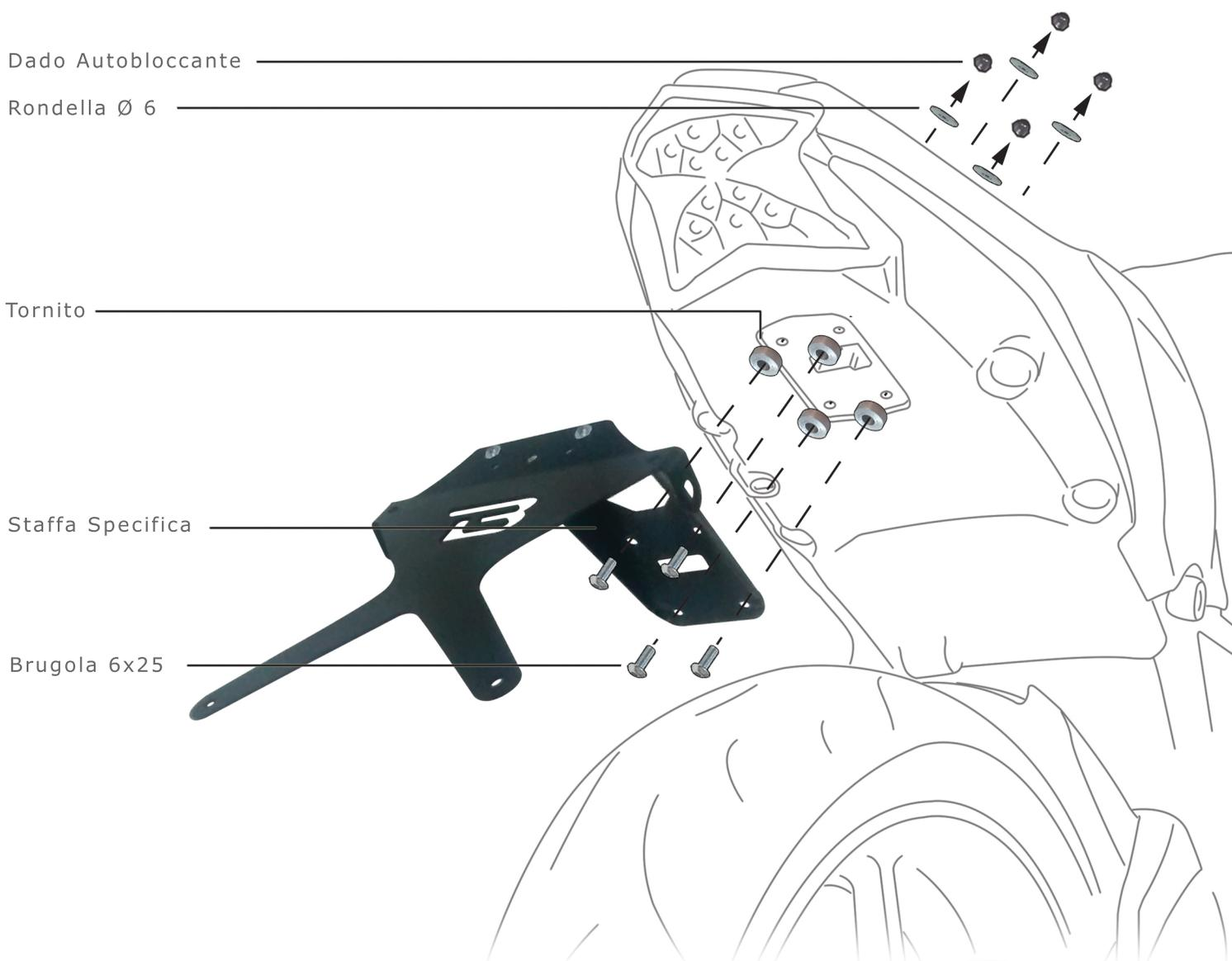
NOTE: SI CONSIGLIA, DI MANTENERE UN'INCLINAZIONE NON SUPERIORE A 30° PER NON INCOMBERE IN SANZIONI DEL CODICE DELLA STRADA E PER EVITARE POSSIBILI ROTTURE STRUTTURALI
